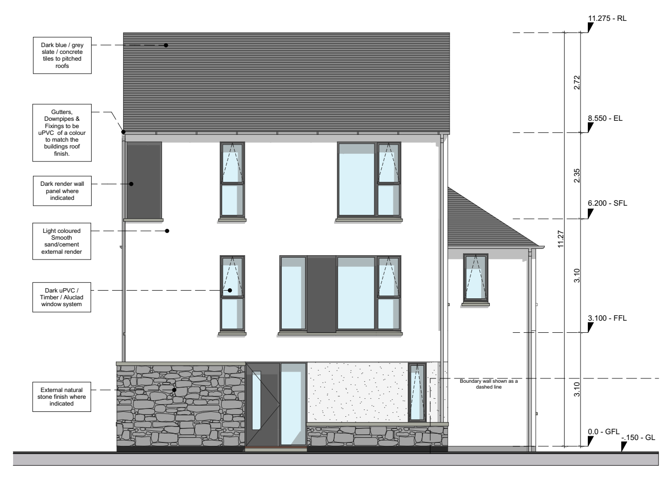
E-02 Side Elevation Type D2 1:100
